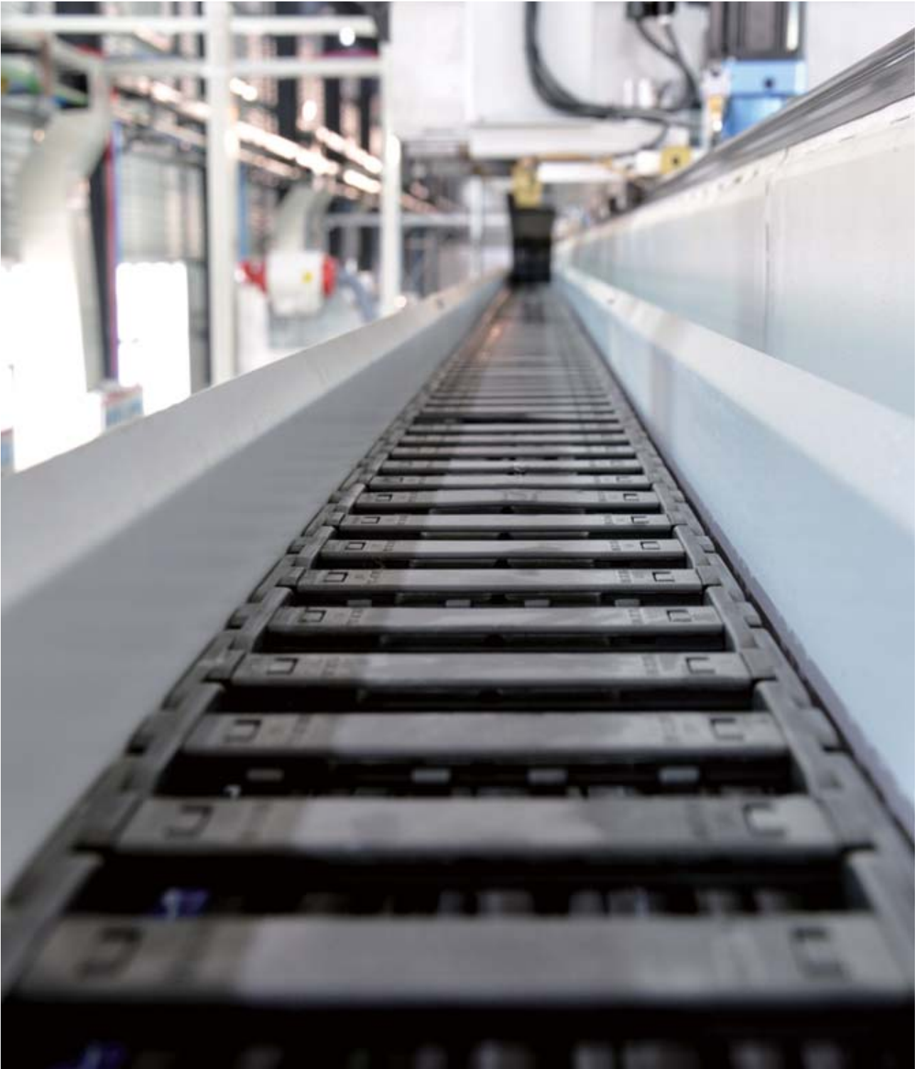
C03电缆拖链用于保护长行程机器人电缆 C03 cable carriers protects long-stroke robot cables
