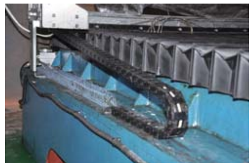
玻璃钢缠绕机 Filament-wound machine
